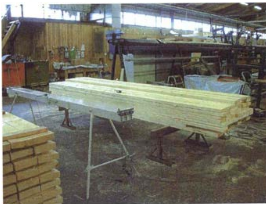
Figur 2. Mätbalk för deformationsmätning.
