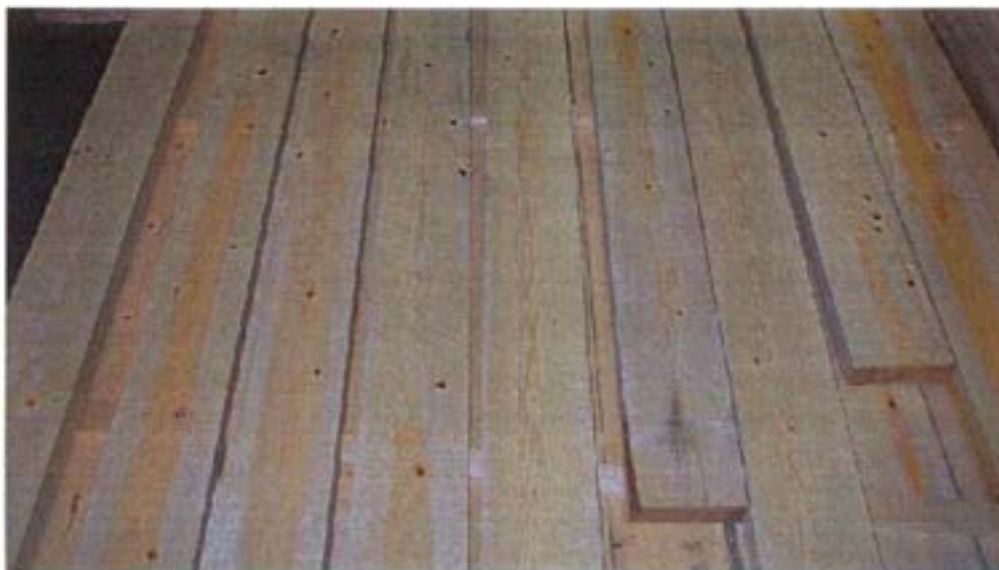
Figur 4. Virkesytor på 63 mm referenstorkningen.
